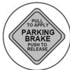
Robinet du frein de stationnement du camion porteur
