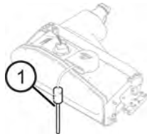
Figura 5: Tanque de DEF
